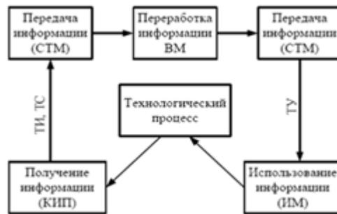
структурная схема автоматической системы управления
