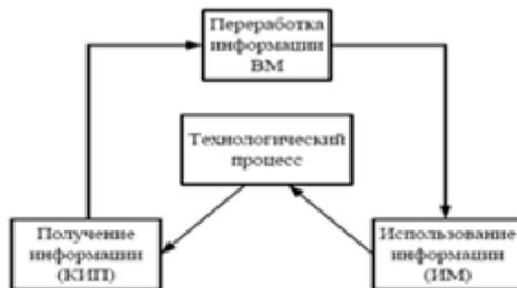
структурная схема частичной автоматизации - местной автоматизации
